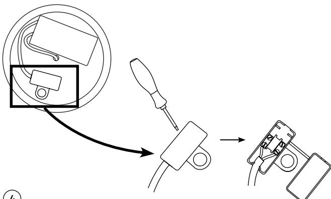
Ouvrir le petit boîtier plastique présent dans le pavillon de la suspension à l'aide d'un petit tournevis plat.
