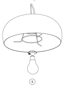
Placer la pastille sur la carcasse à l'aide des trois bras. Place the pastille on the carcass through its three arms.
