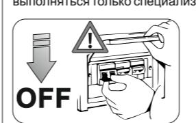
**ATTENZIONE:** Collegare l'apparecchio se la tensione di rete è attivata potrebbe danneggiare irrimediabilmente i LED.
